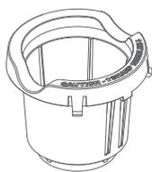
Pour retirer le support à capsule K-Cup® de la cafetière, soulevez la porte du support à capsule, saisissez le dessus du support à capsule K-Cup® d'une main et tirez dessus jusqu'à ce qu'il se libère. Après le nettoyage, enclenchez le support à capsule K-Cup® avec l'ouverture en vous guidant sur les deux rainures à l'avant et enclenchez-le en place.
